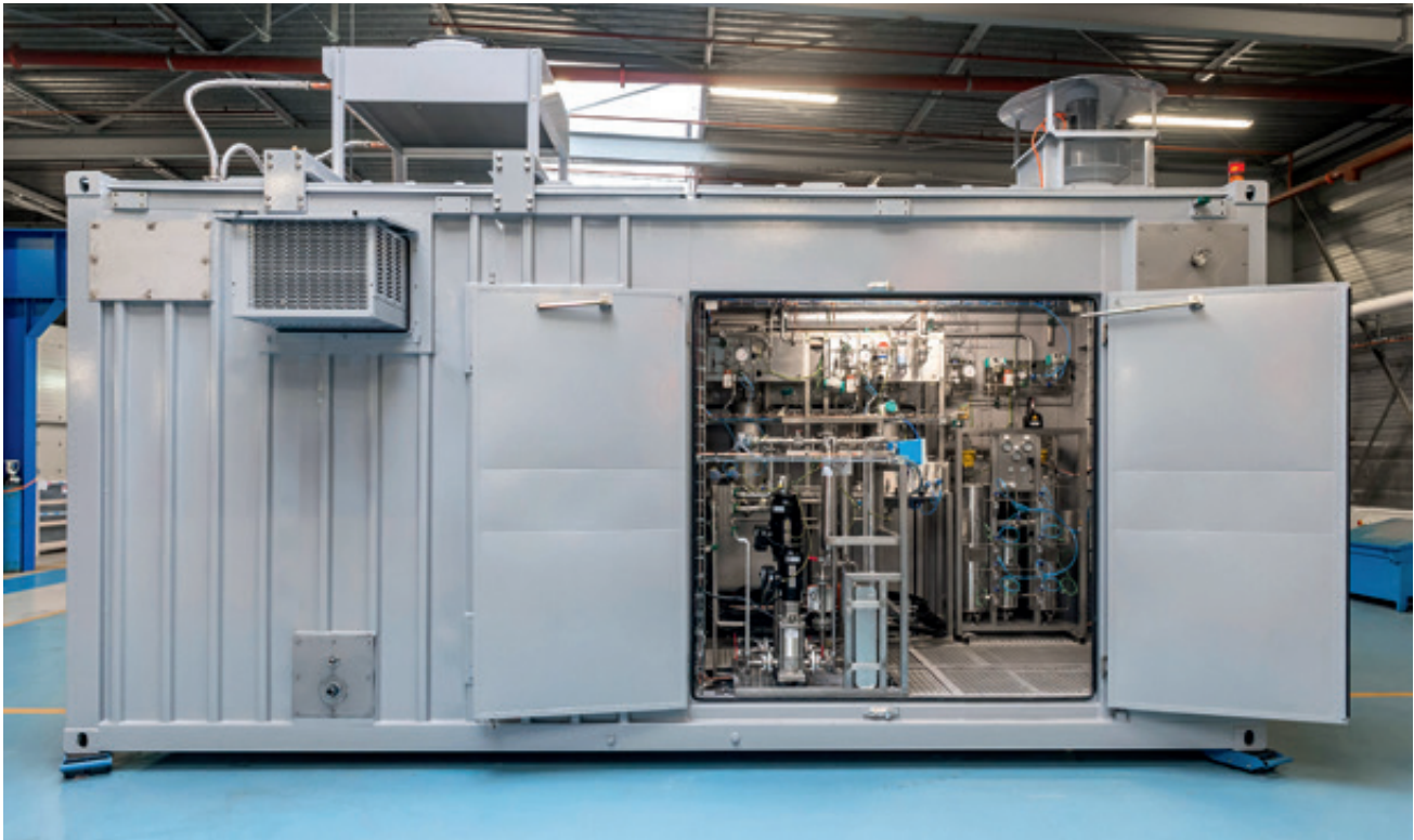
Abb. 2: Im Rahmen des Teilprojekts MethFuel entwickeltes PEM-Elektrolyse-System
